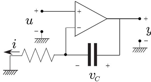
Sia  $u$  la tensione di ingresso,  $y$  la tensione di uscita e  $i$  la corrente che attraversa il resistore e  $v_C$  la tensione ai capi del condensatore.
