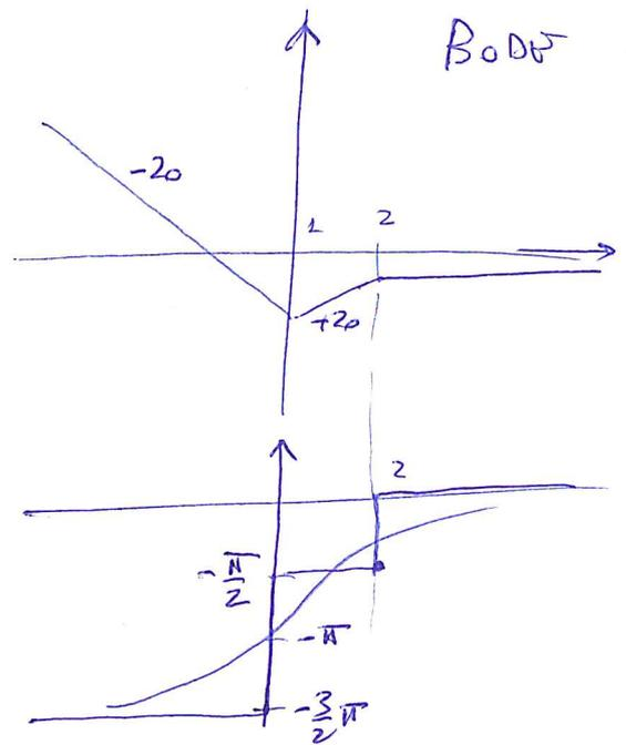
2)  $G(j\omega) = \frac{1-\omega^2+2j\omega}{j\omega(-2+j\omega)} = \frac{(1-\omega^2+2j\omega)(-2-j\omega)}{j\omega(4+\omega^2)} = \frac{-2+2\omega^2+2\omega^2+j\omega(-4\omega^2-4)}{-j\omega(4+\omega^2)}$
