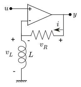
Si tratta di in circuito con un amplificatore operazionale una resistenza e una induttanza.
