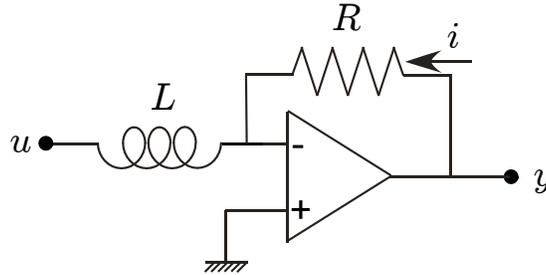
Si tratta di un circuito con un amplificatore operazionale con impedenze di ingresso infinite ai morsetti  $+$  e  $-$  e tale che
