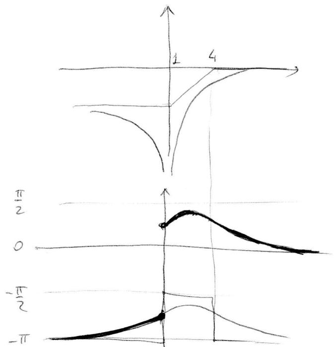
$$2) G(j\omega) = \frac{1-\omega^2}{(4+j\omega)(-1+j\omega)} = \frac{(1-\omega^2)(4-j\omega)(-1-j\omega)}{(16+\omega^2)(1+\omega^2)}$$
