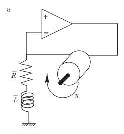
Si tratta di un motore in continua alimentato da un amplificatore operazionale. Siano J il momento di inerzia e b la costante di attrito del motore, R la resistenza e L l'induttanza del motore e H la costante elettromeccanica. Supponiamo inoltre che l'amplificatore operazionale abbia amplificazione finita A.
