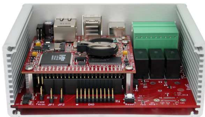
Figura 4.3: Immagine del miniPC (con scatola semi-aperta)
