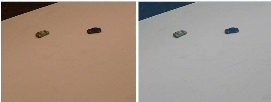
Figura 9: Immagine grezza ottenuta dalla telecamera. Figura 10: Bilanciamento del bianco.
