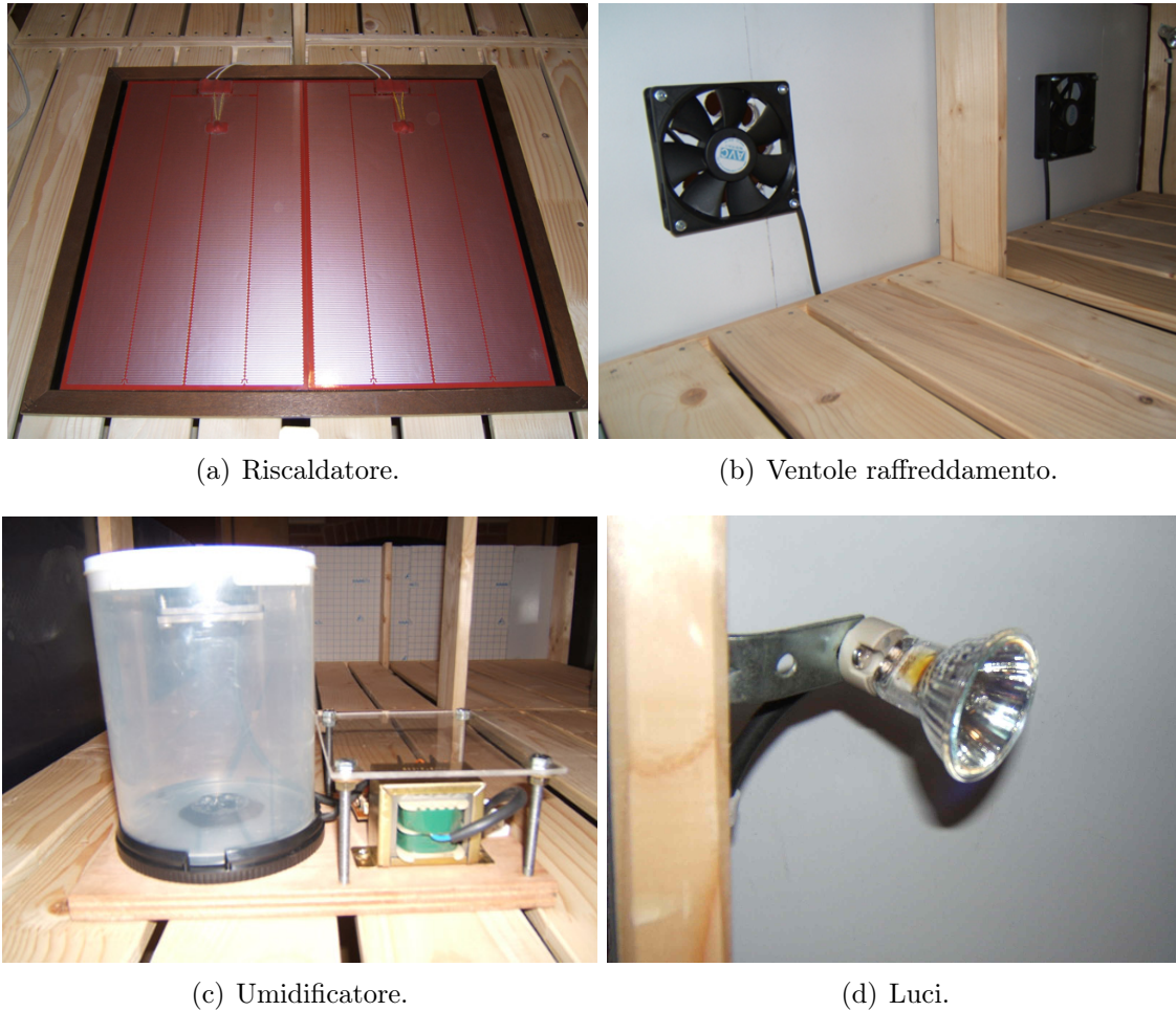
Figura 6.2: Attuatori modello serra.
