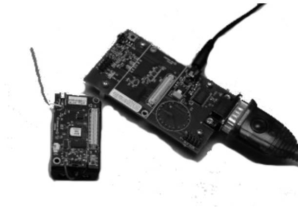
**Figura 5.2.** Nodo Mica 2 e a fianco la “programming board” necessaria.
