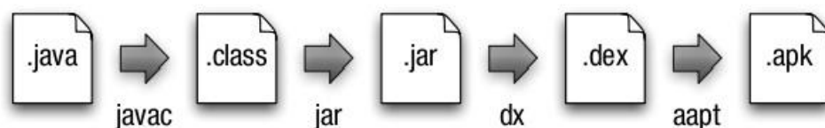
Figura 1.2: Catena di compilazione di un programma per un sistema Android.
