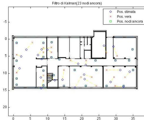
Figura 12: Mappa della rete localizzata tramite filtro di Kalman esteso
