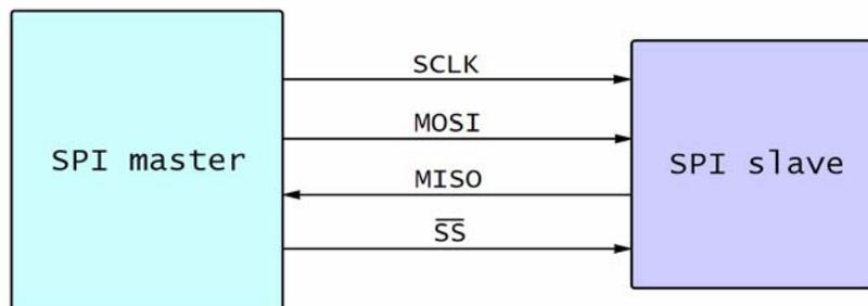
Figura 4.4: Collegamento mediante bus SPI tra un singolo master ed un singolo slave. Sono presenti quattro segnali: SCLK serial clock; MOSI master data output, slave data input; MISO master data input, slave data output e  $\overline{SS}$  slave select.
