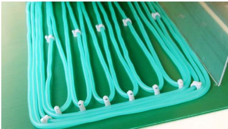
Figura 3.4: Al di sotto del “pavimento” della serra è posto un tubicino di materiale siliconico, il quale quando necessario è percorso da acqua calda, in modo da costituire una forma di riscaldamento “di mantenimento”.
