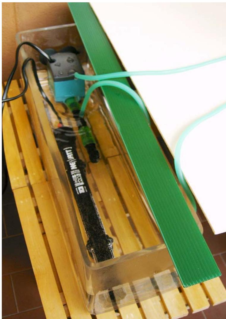
Figura C.3: Contenitore per l'acqua impiegata nel riscaldamento a pavimento; si possono notare il riscaldatore e la pompa da acquario posti al suo interno, ed il tubo flessibile in materiale siliconico di cui è costituita la serpentina posta nella parte inferiore della serra.
