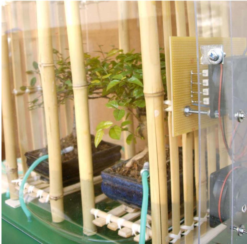
Figura 3.3: Particolare della serra. In alto a destra si intravedono parte delle resistenze ceramiche (bianche) che contribuiscono al riscaldamento; si possono inoltre notare i tubicini colorati di materiale siliconico che, quando richiesto, possono fornire acqua ai bonsai.
