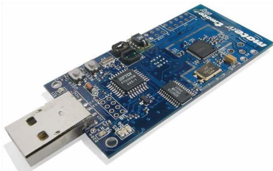
Figura 2.1: Il modulo wireless a bassa potenza Telos.
