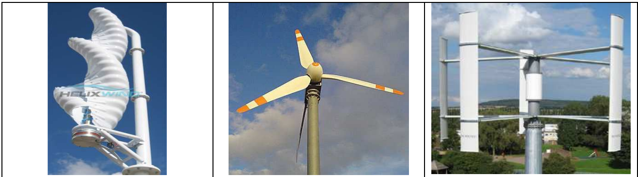
Fig. 5.4.5 Tipi di rotore eolici: Savonius, a 3 pale e Darrieus.
