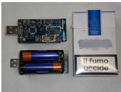
Fig. 23: Un nodo Tmote Sky confrontato con un pacchetto di sigarette per dare un'idea delle dimensioni.
