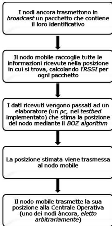
**Fig. 28:** Sequenza delle operazioni svolte per la localizzazione.
