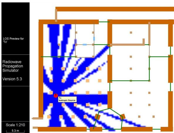
Fig. 16: Esempio di percorso LOS di un nodo trasmettitore.
