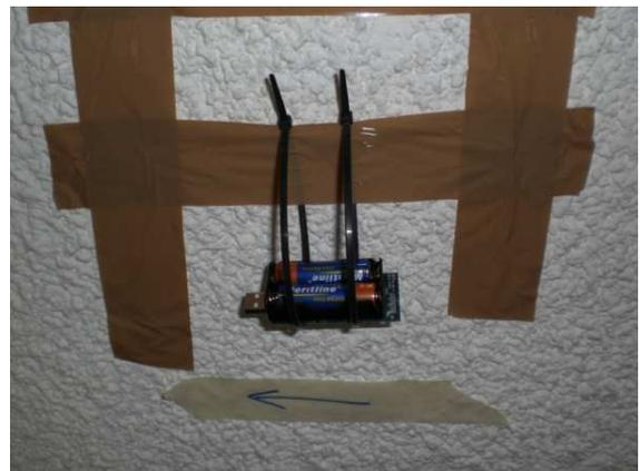
Fig. 45: Struttura utilizzata per fissare i nodi ancora nell'ambiente.
