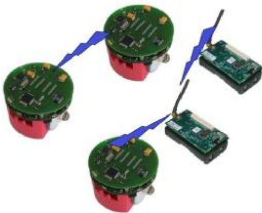
Fig. 28. Versione degli e-Puck con radio integrata.
